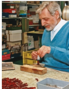
Die Feder hält die 2 Wäscheklammern-Hälften zusammen.
